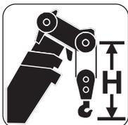
Hook block • Unterflasche • Crochet-moufle • Gancho • Ganci • Крюковой блок (t)
